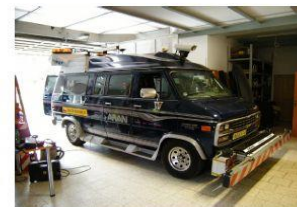
Multifunkční diagnostické vozidlo ARAN (Automatic Road Analyzer)
